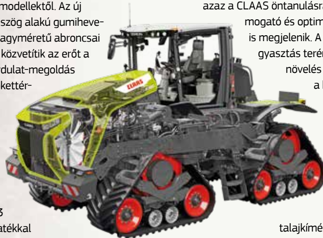
A bevált XERION koncepció: erős csavarozott váz + két kormányzott híd
