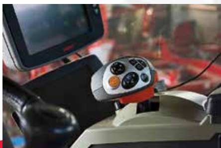
A terminálról fokozatmentesen állítható a hidromotor
